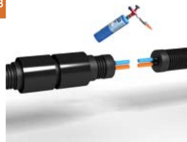
Установите термоусадочные колпачки, плавно нагревая их. Обожмите термоусадочные колпачки на кожух трубопровода и вокруг напорных труб. Используйте защитные перчатки обязательно.
