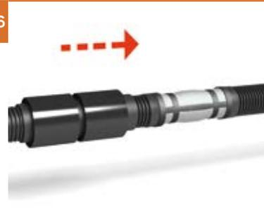
Надвиньте прямую гильзу, пока оба конца предварительно изолированного трубопровода не будут покрыты. Затем надвиньте оба термоусадочных рукава так, чтобы каждый из них наполовину покрывал прямую гильзу и кожух трубопровода.
