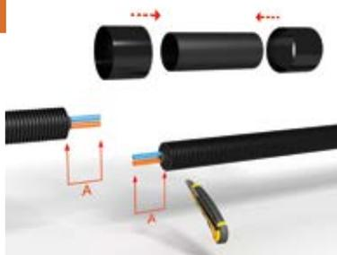
Осторожно удалите оболочку трубопровода и слои изоляции, чтобы не повредить напорные трубы внутри. Длина напорных труб обозначена значком А. Длина зависит от диаметра напорных труб:
